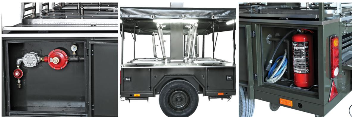
Оборудования, которые производятся в соответствии с требованиями и эксплуатируются с газовой системой может быть подключен к системе через внешние газовые трубы. Оборудование может быть производится также с танком для жидкого LPG и системой испарителя. Газовая система достаточно для эксплуатации всех приборов одновременно и у нас есть огнетушитель для защиты от пожара.
