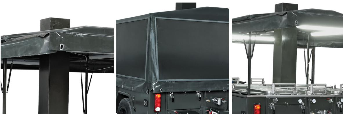
Верхняя защитная рама была разработана, чтобы не держать дождь или снег на нем. Выходе из трубы края, которые даны от середины верхней защиты, изолированные против водный поток.
