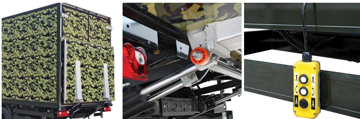
Есть система регулировки высоты опускания и подъема, в целях упрощения работы, состоит из параболические Z ножницы и гидравлический демпфер ограничивает чрезмерное движение колесной базы. Система гидравлического лифта, который можно регулировать с панели управления, может быть использован параллельно задней крышки. Он имеет 1000 кг. грузоподъемность.
