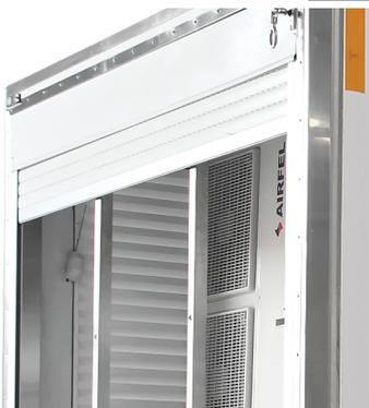
Изолированные, кондиционирование, высокопрочные рольставни помещаются в нужное место на Мобильной Полевой Кухне. Рольставни могут управляться механическим и дистанционным управлением.
